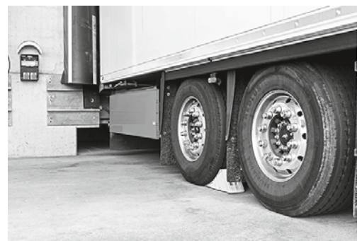
7 Mit Keil gesichertes Fahrzeug an einer Rampe
