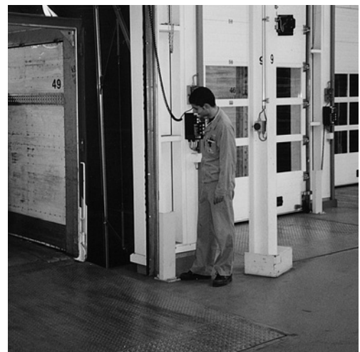
3 Dieser Bediener hat für das Anpassen der Rampe eine gute Sicht.
